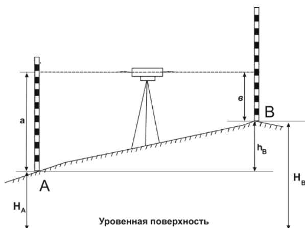
Рис. 8. Схема нивелирования из середины
