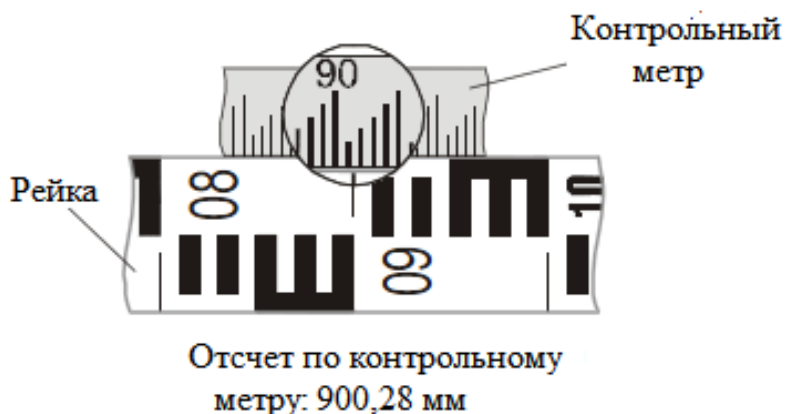
Рис. 30. Схема измерения метровых интервалов рейки в прямом ходе
