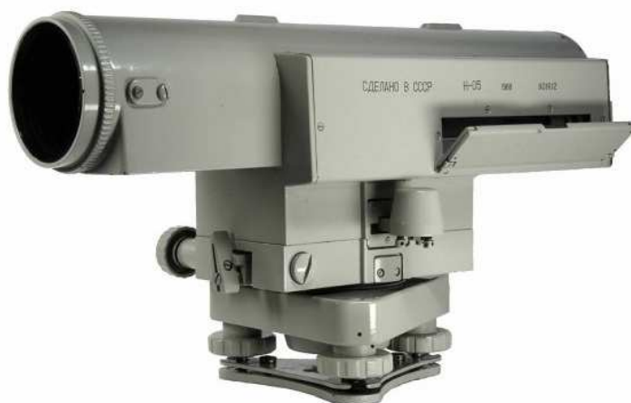
Рис. 13. Высокоточный нивелир Н-05
